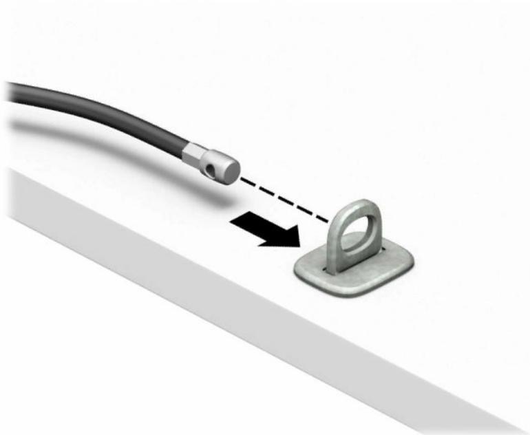
4. Se a configuração da sua estação de trabalho inclui um monitor que você deseja proteger, separe as duas hastes da tesoura metálica da trava do monitor e insira a trava no slot de segurança na parte traseira do monitor (1). Feche a tesoura (2) para prender a trava no lugar e, em seguida, deslize o guia do cabo através do centro da trava do monitor (3).
