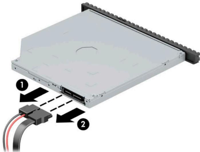
4. ドライブの背面にあるリリースレバーを押し (1)、ドライブをスライドさせてフロントパネルから取り出します (2)。
