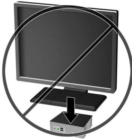
Figura A-5 Non collocare un monitor sul thin client
