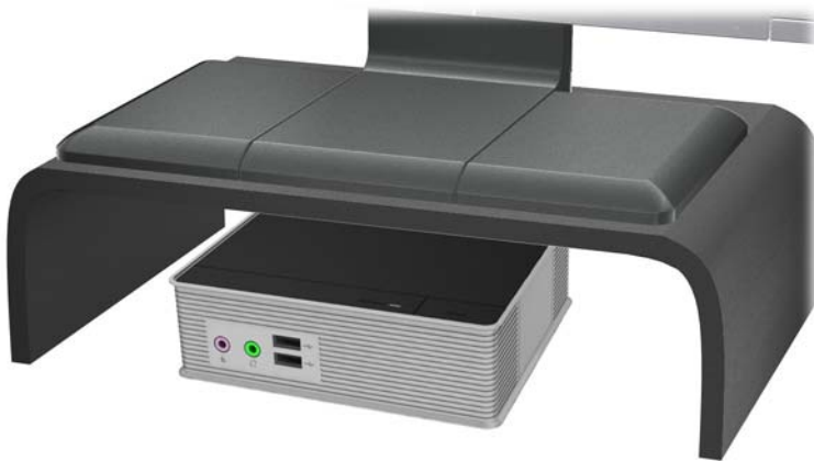
Figura A-3 Sotto il supporto del monitor con almeno 2,5 cm di spazio libero
