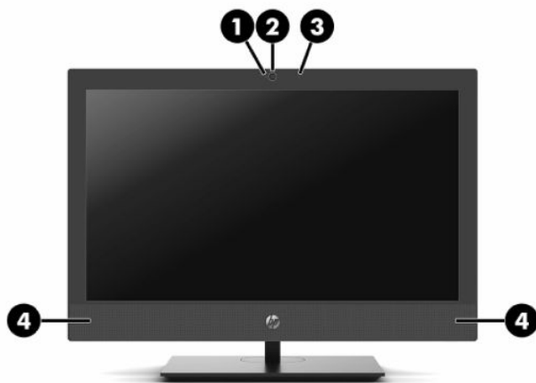
ตาราง 1-5 ส่วนประกอบด้านหน้าของ HP ProOne 400 ขนาด 20 นิ้ว
