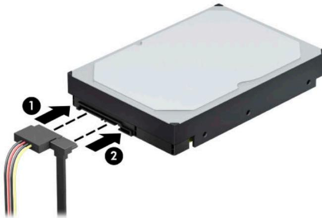
8. Se si installa una nuova unità, collegare l'estremità opposta del cavo dati al connettore appropriato posto sulla scheda di sistema.
