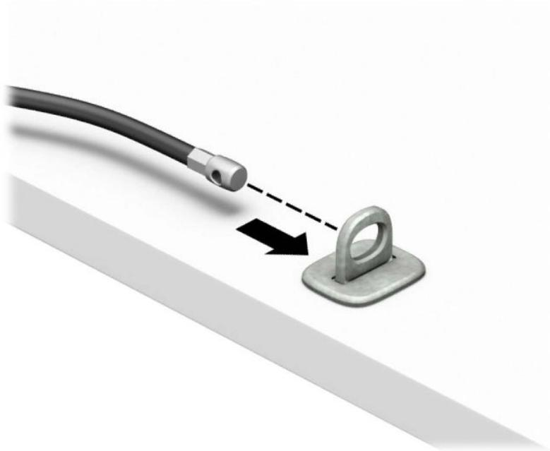
4. Smontare le due forbici di blocco del monitor e inserire il dispositivo di blocco nello slot di sicurezza sul retro del monitor (1), chiudere le forbici per fissare il blocco in posizione (2), quindi far scorrere la guida del cavo attraverso il centro del blocco del monitor (3).
