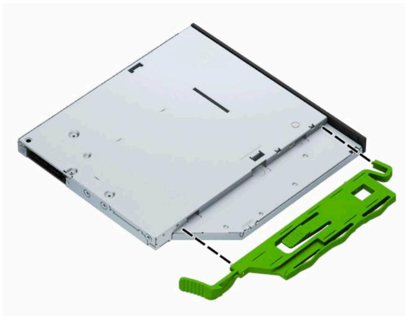
6. Far scorrere l'unità ottica attraverso il frontalino fino a sistemarla nell'alloggiamento (1), in modo che la levetta sul retro dell'unità si blocchi in posizione (2).
