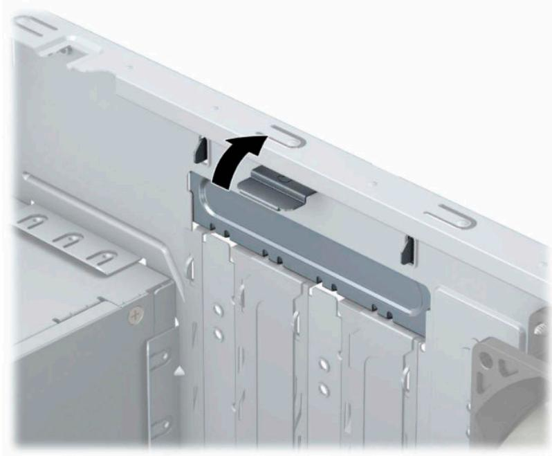
4. Sul retro dello chassis del computer, individuare sulla scheda di sistema il corretto zoccolo di espansione vuoto e lo slot di espansione corrispondente.
