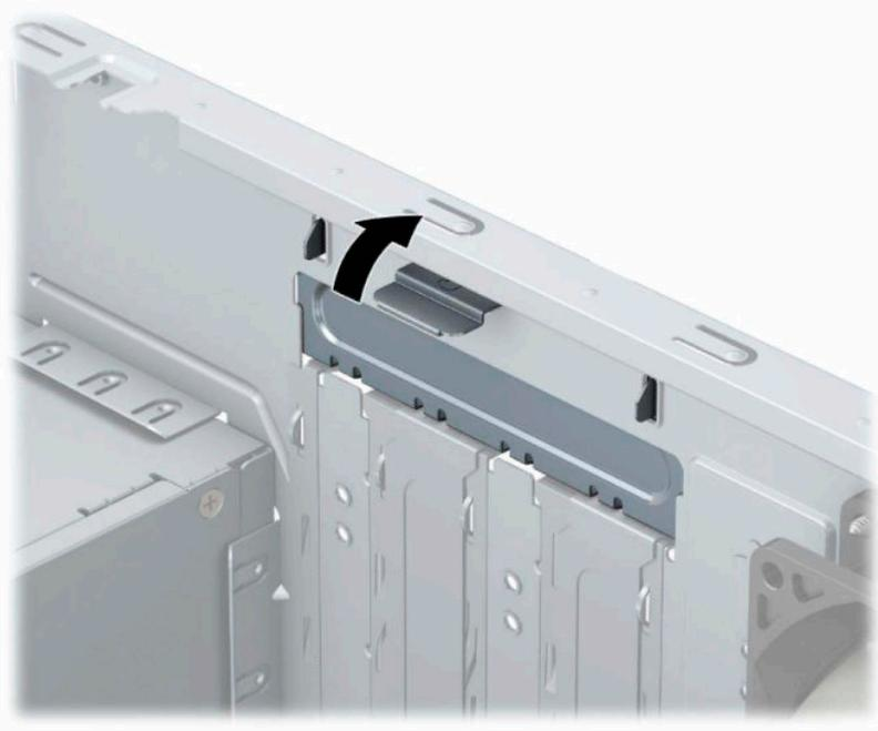
4. Найдите на системной плате подходящий свободный разъем расширения и соответствующее гнездо расширения на задней панели корпуса компьютера.
