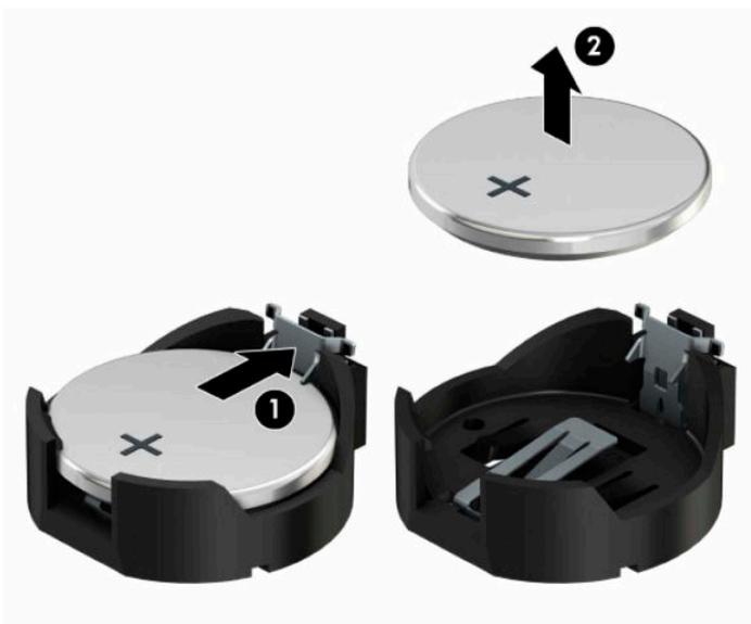
6. Чтобы установить новую батарею, вставьте ее одним краем под выступ держателя (1) положительным полюсом вверх. Нажмите на другой край батареи, чтобы фиксатор захватил его (2).
