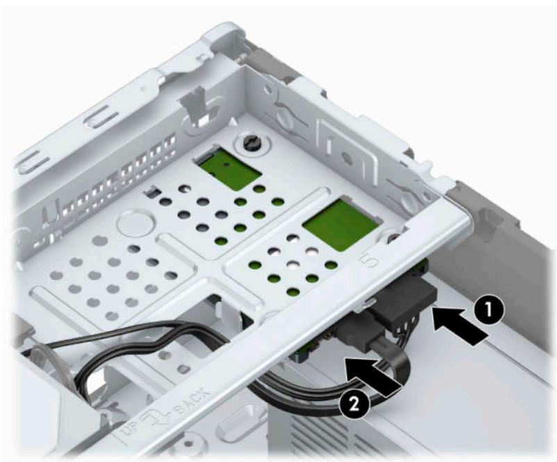
5. При установке нового привода подключите другой конец кабеля данных к соответствующему разъему системной платы.
