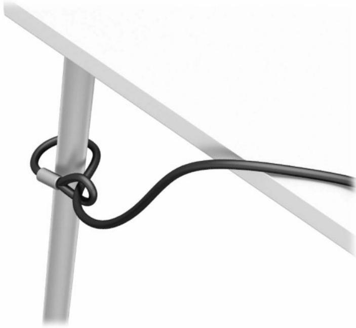
3. Пропустите защитный тросик через фиксатор защитного тросика.
