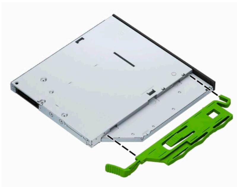
6. Задвиньте оптический дисковод в отсек через лицевую панель (1) так, чтобы фиксатор защелкнулся на корпусе (2).
