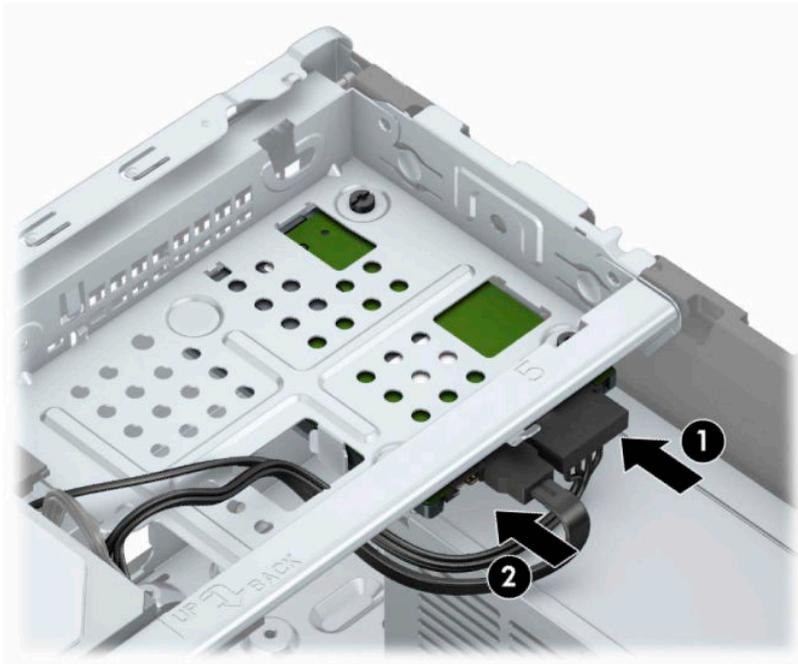
5. 如果要安裝新的磁碟機，請將資料排線另一端連接到適當的系統主機板接頭。
