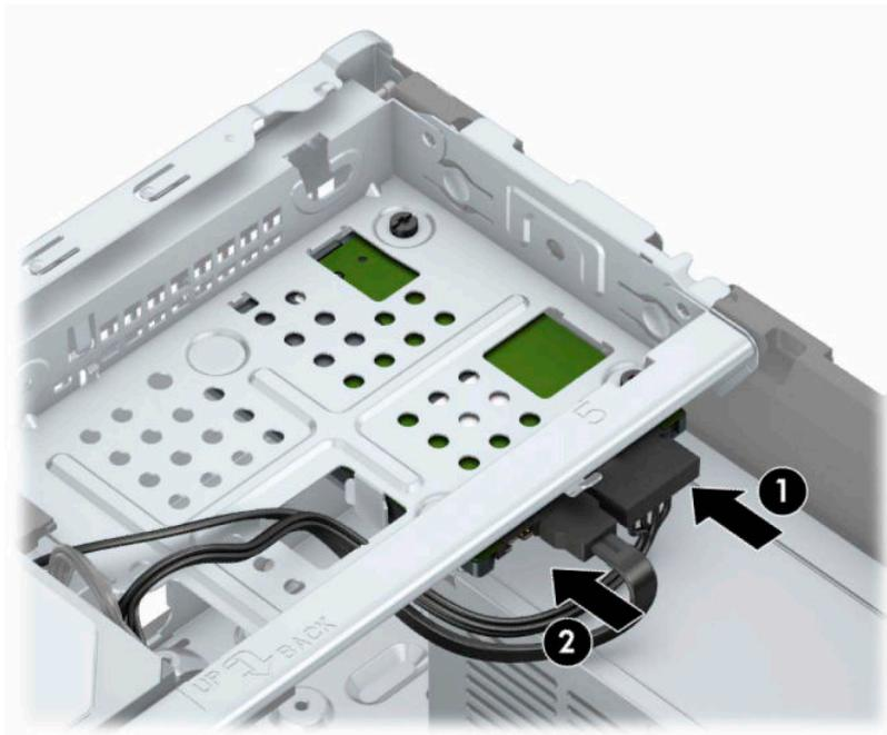
5. Jika Anda memasang drive baru, sambungkan ujung kabel data lainnya ke konektor papan sistem yang sesuai.
