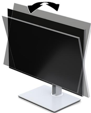
2. Schwenken Sie den Displaykopf nach links oder rechts, um einen optimalen Betrachtungswinkel zu erhalten.
