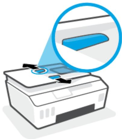
2. ドキュメントフィーダーに、印刷面を上にして原稿をセットします。
