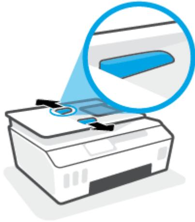
2. Legen Sie das Original mit der bedruckten Seite nach oben in den automatischen Vorlageneinzug ein.
