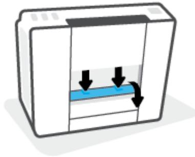
6. Entfernen Sie das eingeklemmte Papier.
