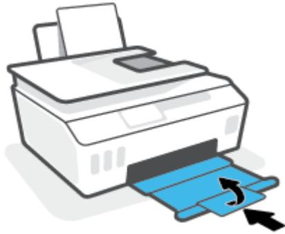
2. Öffnen Sie die vordere Klappe des Druckers.
