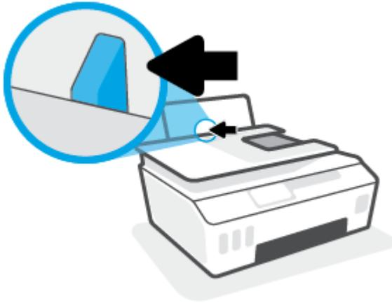
3. Legen Sie einen oder mehrere Briefumschläge rechtsbündig in das Zufuhrfach ein und schieben Sie den Stapel Briefumschläge bis zum Anschlag nach unten.
