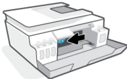
3. Drücken Sie die Druckkopfverriegelung zum Öffnen an der Seite nach unten.
