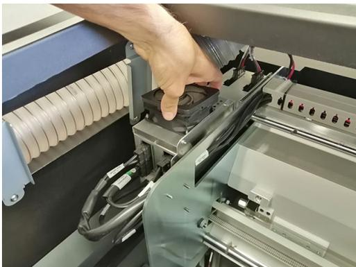
3. Cambie el filtro anterior del ventilador por el nuevo que se proporciona en el kit de mantenimiento de la impresora. Asegúrese de volver a colocarlo correctamente: debe cubrir la superficie cuadrada del ventilador.
