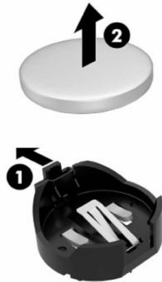
10. Para inserir a nova bateria, deslize uma extremidade da bateria de substituição para baixo da aba do suporte **(1)**, com o lado positivo virado para cima. Pressione a outra extremidade até o grampo engatar na outra extremidade da bateria **(2)**.
