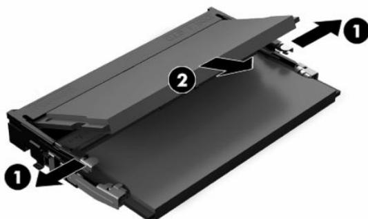
12. Deslize o novo SODIMM **(1)** para dentro do soquete num ângulo de aproximadamente 30°, depois pressione o SODIMM para baixo **(2)** de forma que as travas se encaixem corretamente.
