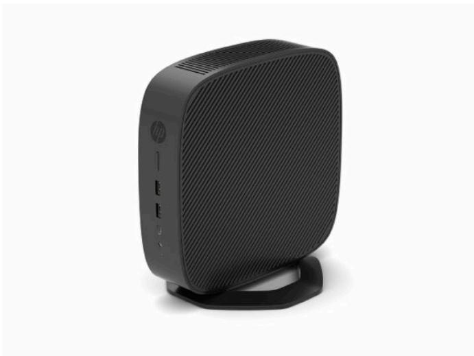
2. **Vertical Minus** - esta orientação costumam ser usada para montar o thin client em uma superfície plana na vertical com o logotipo da HP posicionado na parte inferior, de cabeça para baixo.
