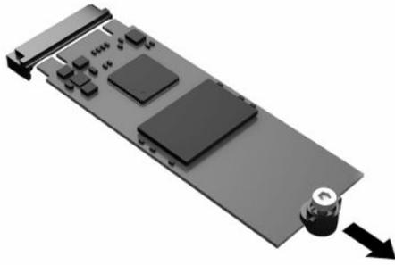
11. Puxe o kit de parafuso do módulo de armazenamento flash e conecte-o ao módulo de armazenamento flash de reposição.
