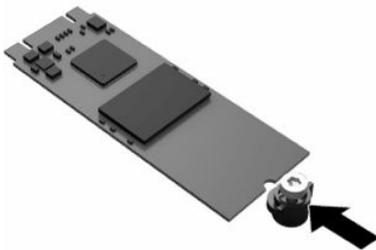
12. Schieben Sie das neue Flash-Speicher-Modul in den M.2-Steckplatz auf der Systemplatine und drücken Sie die Modulkontakte fest in den Steckplatz.
