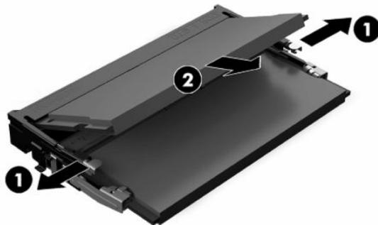
11. Deslize o novo módulo de memória (1) para dentro do soquete num ângulo de aproximadamente 30°, depois pressione o módulo de memória para baixo (2) de forma que as travas se encaixem corretamente.
