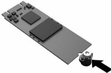
12. Deslize o novo módulo de armazenamento flash no soquete M.2 na placa do sistema e pressione os conectores do módulo firmemente no soquete.
