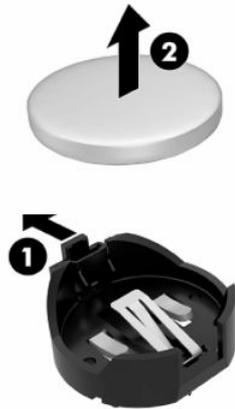
10. Para inserir a nova bateria, deslize uma borda da bateria de reposição para baixo do ressalto do compartimento (1), com o lado positivo voltado para cima. Empurre a outra borda da bateria para baixo até que a presilha se encaixe na outra borda da bateria (2).
