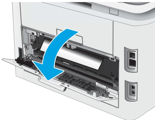
2. Si hay papel visible en la bandeja de salida, tire del borde delantero para extraerlo. Utilice ambas manos para extraer el papel atascado sin que se rasgue.
