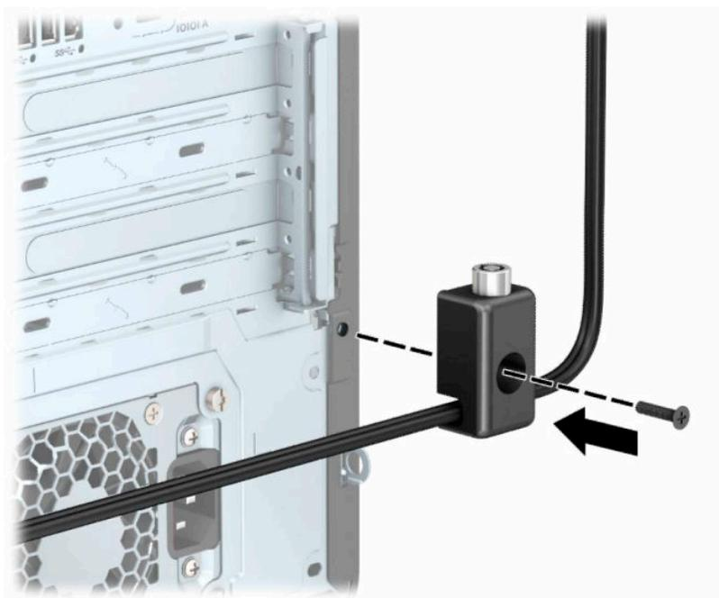
9. Setzen Sie das Steckerende des Sicherheitskabels in die Sperre ein **(1)** und drücken Sie gegen den Knopf **(2)**, um die Sperre zu aktivieren. Verwenden Sie den im Lieferumfang enthaltenen Schlüssel, um die Sperre zu lösen.
