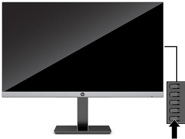
Lorsque le moniteur est mis sous tension pour la première fois, un message État du moniteur s'affiche pendant 5 secondes. Le message indique à quelle entrée correspond le signal actif actuel, l'état du réglage de la mise en source du commutateur automatique (activé ou désactivé ; le paramètre par défaut est Activé), la résolution de l'écran actuelle préréglée et la résolution d'affichage prédéfinies.
