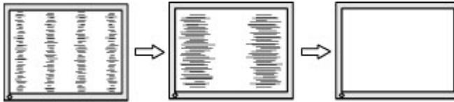
3. Sollte nach dem Anpassen des Takts die Anzeige weiterhin flimmern oder verschwimmen oder sollten weiterhin Streifen erscheinen, passen Sie die Phasenlage an.
