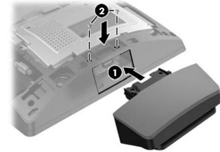
4. Richten Sie die Laschen der rückseitigen Abdeckung des Displaykopfs an den Steckplätzen am Displaykopf aus. Legen Sie die Abdeckung auf den Displaykopf, und schieben Sie sie dann nach unten, bis sie einrastet.
