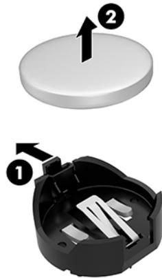
9. Para insertar la batería nueva, deslice un borde de la batería de reemplazo en el soporte con el lado positivo hacia arriba (1). Presione uno de los bordes hacia abajo hasta que la abrazadera se ajuste sobre el otro borde de la batería (2).
