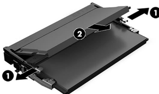
9. Deslice el nuevo módulo de memoria (1) en la ranura en un ángulo de aproximadamente 30 grados y luego presione el módulo de memoria hacia abajo (2) para que los pestillos de bloqueo encajen en su posición.
