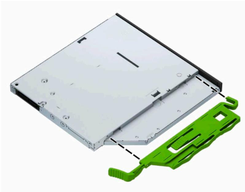
9. Deslize a unidade óptica totalmente para dentro do compartimento através do painel frontal (1) até a trava na parte traseira da unidade encaixar no lugar (2).
