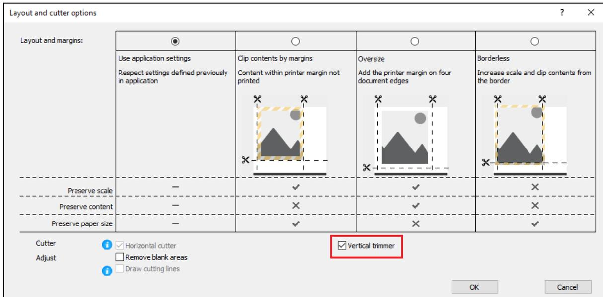
Pour activer le couteau vertical à partir des pilotes V4, vérifiez l'option Couteau vertical accessible sous Options du rouleau dans l'onglet Sortie.
