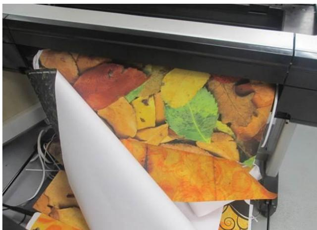
**Dépannage :** N'empilez pas plus de 3 grands tracés avec une densité d'encre élevée. Lors de l'impression d'un long tracé, connaissez le processus d'impression et empilez correctement les documents imprimés.
