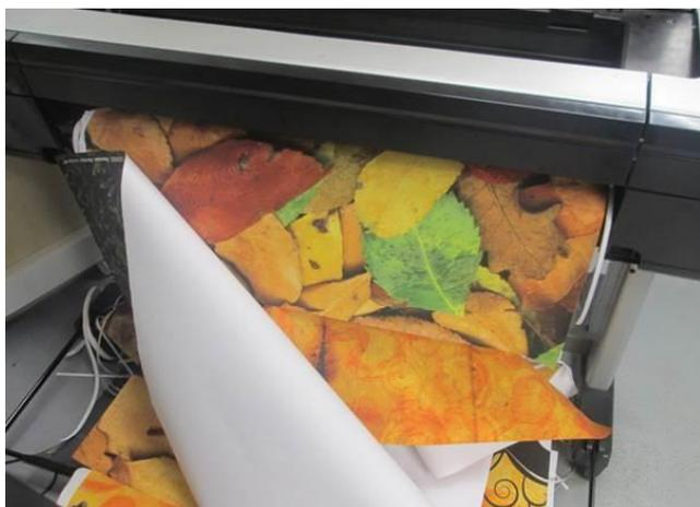
**Risoluzione dei problemi:** Non impilare più di 3 plottaggi con una densità dell'inchiostro elevata. Quando si stampa un plottaggio, considerare il lavoro di stampa e impilare le stampe correttamente.
