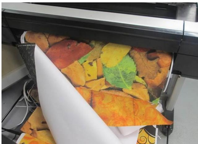
**故障排除：**请勿堆叠超过 3 个墨水浓度较高的长图件。打印长图件时，请注意打印过程并正确堆叠打印件。
