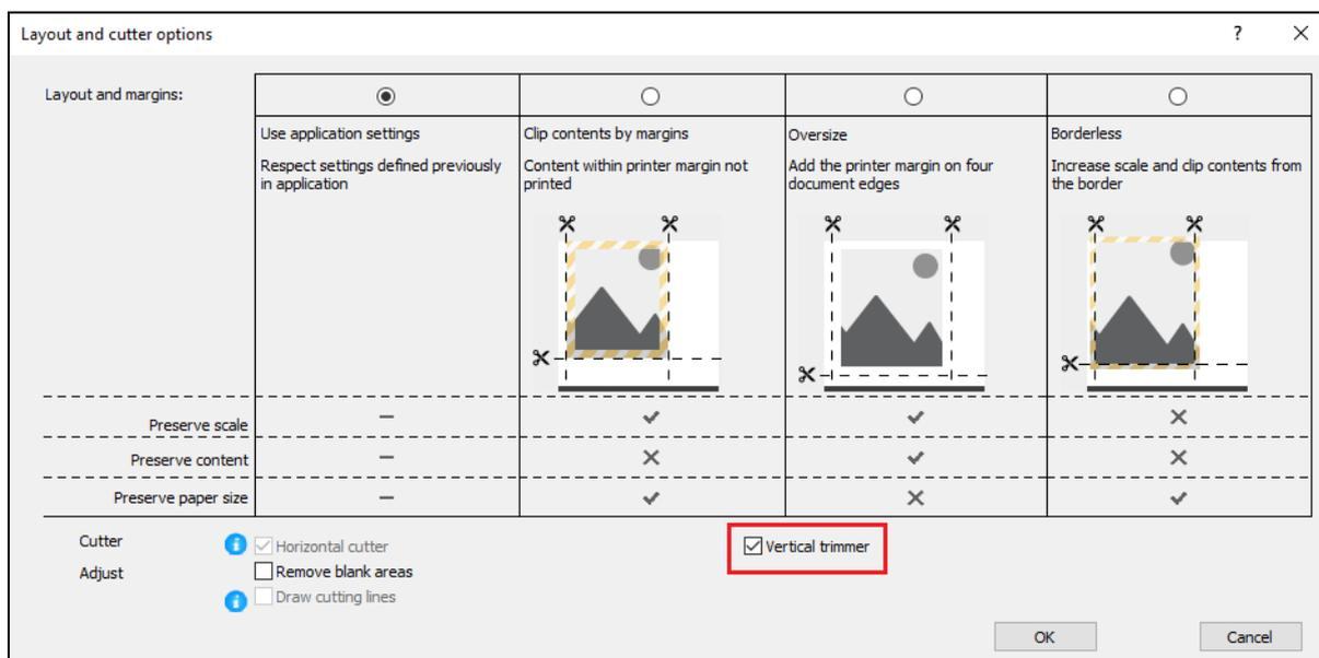
要从 V4 驱动程序中启用纵向切刀，请选中“输出”选项卡中“卷筒选项”下方的“纵向切刀”选项。
