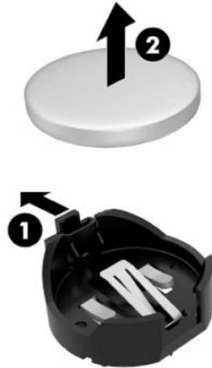
10. Um die neue Batterie einzusetzen, schieben Sie die Austauschbatterie mit dem Pluspol nach oben an einer Seite unter die Nase der Halterung (1). Drücken Sie die andere Seite der Batterie nach unten, bis sie unter der Klammer einrastet (2).
