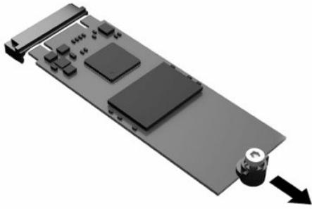
11. Ziehen Sie das Schraube-Kit vom Flash-Speicher-Modul weg und befestigen Sie es am Ersatz-Flash-Speicher-Modul.
