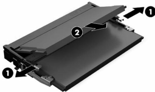
11. Schieben Sie das neue Speichermodul (1) in einem Winkel von ca. 30° in den Steckplatz und dann drücken Sie das Speichermodul nach unten (2), so dass die Verriegelungen ihn einrasten.
