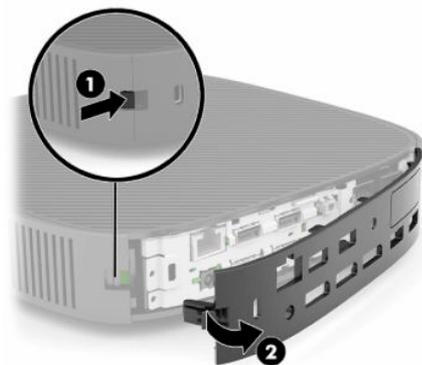
8. Drücken Sie auf die Verriegelung der Zugriffsblende (1), um die Zugriffsblende zu lösen.
