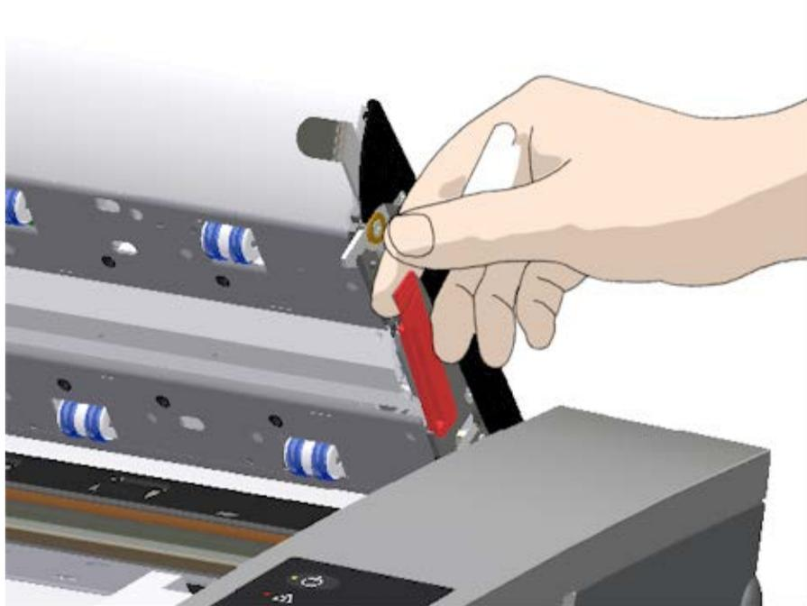
5. Greifen Sie den Rand der weißen Hintergrundplatte mit den Fingern, und ziehen Sie sie aus dem Scanner heraus.
