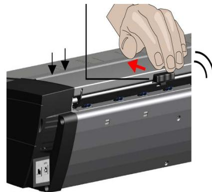
2. Ziehen Sie die oberste der beiden Tasten auf der Rückseite des Scannerdeckels in der Nähe des Tastenfelds nach innen und lassen Sie sie dann los.
