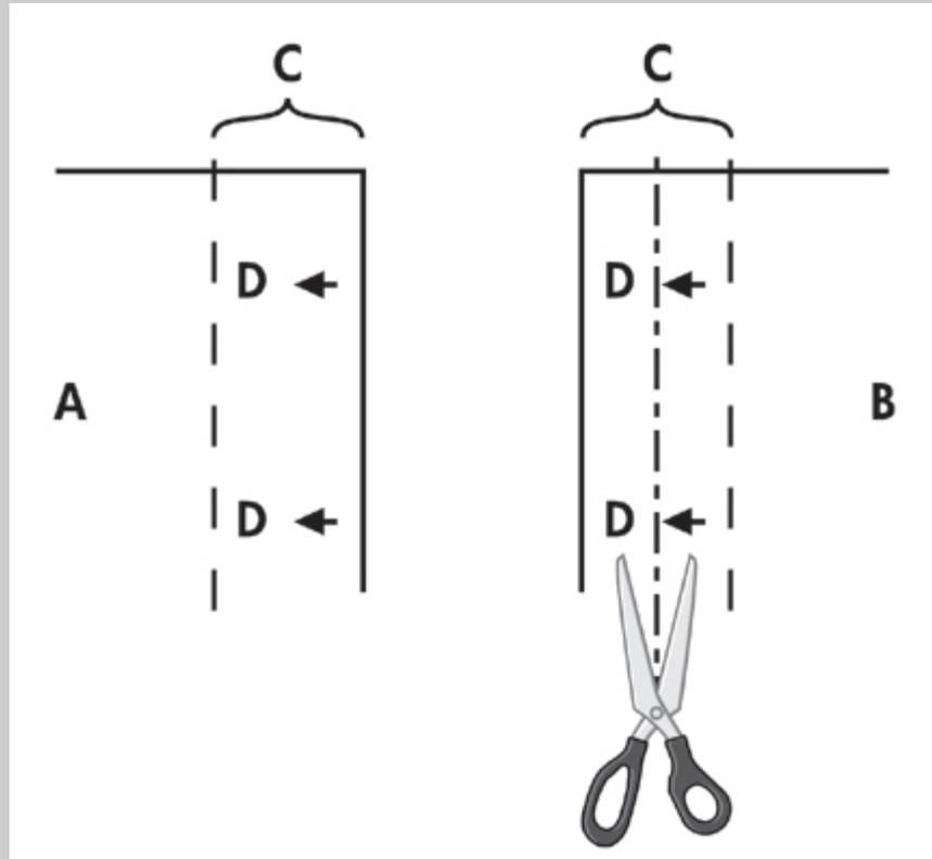
Bei aktivierter Kachelungsoption werden Schnittlinien und Klebmarkierungen (D) gedruckt, die zur horizontalen (siehe obige Abbildung) und vertikalen Verbindung der Einzelausschnitte dienen.
