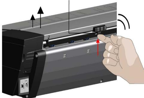
1. Heben Sie den kleinen Hebel unterhalb der größeren Taste auf der Rückseite des Scannerdeckels in der Nähe des Tastenfelds an.
