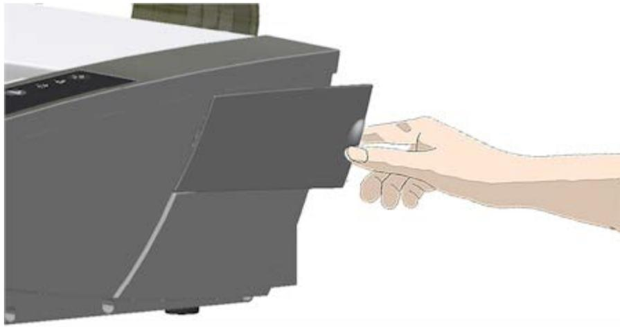
3. Die gesamte Lampeneinheit muss ausgetauscht werden. Eine Lampeneinheit besteht aus einer in einer Reflektorhalterung angebrachten Lampe und einem fest montierten Stromversorgungsanschluss. Am sichtbaren Ende der Lampeneinheit befindet sich ein Griff. Ziehen Sie die Lampeneinheit vorsichtig am Griff aus dem Scanner heraus.
