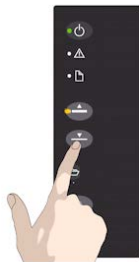
2.按 ATAC 的「向下」鍵可降低壓印板，以符合較厚的原稿
