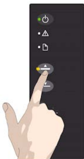
1.按 ATAC 的「向上」鍵可提升壓印板
