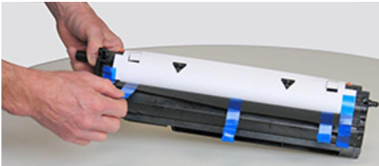
3. Entfernen Sie die orangefarbenen Transportsicherungen von der Bildtrommeleinheit.
