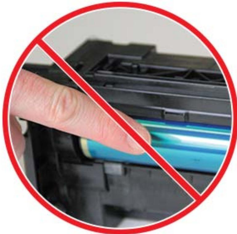
**📝 HINWEIS:** Achten Sie darauf, dass die Bildtrommeleinheit nicht länger als ein paar Minuten dem Licht ausgesetzt ist.
