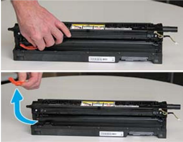
**⚠ PRECAUCIÓN:** Cuando se retira el conector, la unidad de procesamiento de imágenes debe permanecer a nivel. Se puede derramar el contenido de la unidad de procesamiento de imágenes si esta se inclina.
