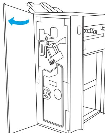
2. Drehen Sie den Knopf gegen den Uhrzeigersinn, um die Heftklammernmagazineinheit vollständig nach vorne zu schieben.
