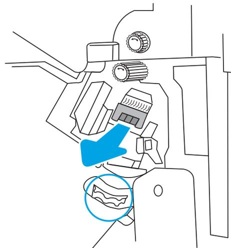
4. Drücken Sie die beiden Laschen am Heftklammernmagazin nach oben, und heben Sie das leere Heftklammernmagazin nach oben aus der Schlitteneinheit des Magazins.
