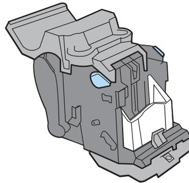
7. Setzen Sie die beiden Schlitteneinheiten wieder in den Broschüreneinsteller ein, indem Sie die farbigen Griffe drücken, bis sie einrasten.
