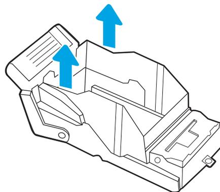
**HINWEIS:** Entsorgen Sie den Schlitten des Heftklammernmagazins nicht. Er muss mit dem neuen Heftklammernmagazin wiederverwendet werden.
