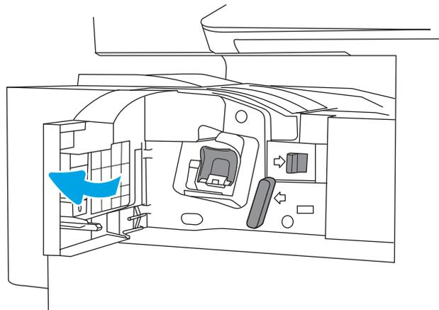
2. Erfassen Sie den farbigen Griff am Schlitten des Heftklammermagazins, und ziehen Sie den Schlitten des Heftklammermagazins gerade heraus.
