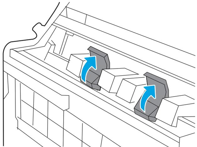
4. Drücken Sie die beiden blauen Laschen nach innen, und heben Sie sie dann nach oben, um die Oberseite der Schlitteneinheit des Heftklammernmagazins zu öffnen.
