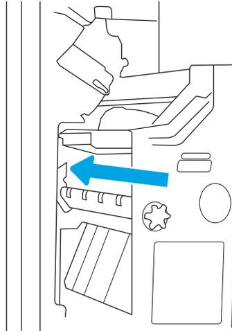
9. Schließen Sie die vordere Klappe des Finishers.
