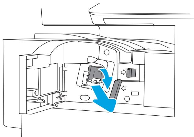
3. Drücken Sie die beiden Laschen am Heftklammernmagazin nach oben, und heben Sie das leere Heftklammernmagazin nach oben aus der Schlitteneinheit des Magazins.
