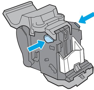
5. Heben Sie jeweils die beiden Laschen an den Heftklammernmagazinen an, und heben Sie die leeren Heftklammernmagazine aus den zugehörigen Schlitteneinheiten.
