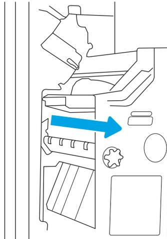
3. Ziehen Sie die farbigen Laschen aus der Einheit heraus und dann aufwärts, um die zwei Heftklammermagazine zu entfernen.
