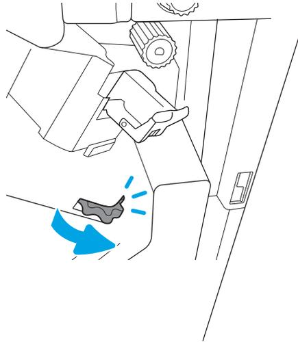
3. Halten Sie den Knopf fest, damit sich die Heftklammernmagazin-Einheit nicht bewegt, ergreifen Sie den farbigen Griff am Schlitten des Heftklammernmagazins, und ziehen Sie den Schlitten des Heftklammernmagazins gerade heraus.
