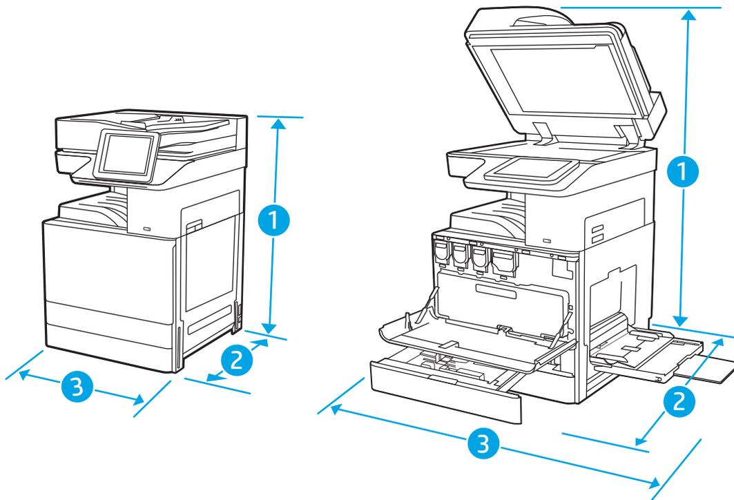
**Table 1-6** Abmessungen der Modelle E78323dn, 78323z, E78325dn, E78325z, E78330dn, E78330z
