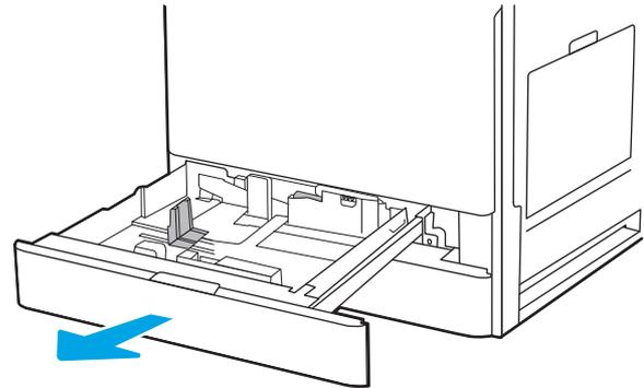
2. Passen Sie vor dem Einlegen von Papier die Papierbreitenführungen an, indem Sie den blauen Verriegelungsschalter an der hinteren Papierführung gedrückt halten, die blaue Papierführung gedrückt halten, die blaue Anpassungsverriegelung an der vorderen Papierführung zusammendrücken und dann die Führungen in die geöffnete Position schieben.
