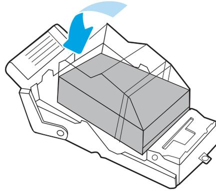
6. Halten Sie den Knopf fest, damit sich die Heftklammermagazin-Einheit nicht bewegt, setzen Sie das neue Heftklammermagazin in die Einheit ein, und drücken Sie dann den farbigen Griff nach innen, bis er einrastet.
