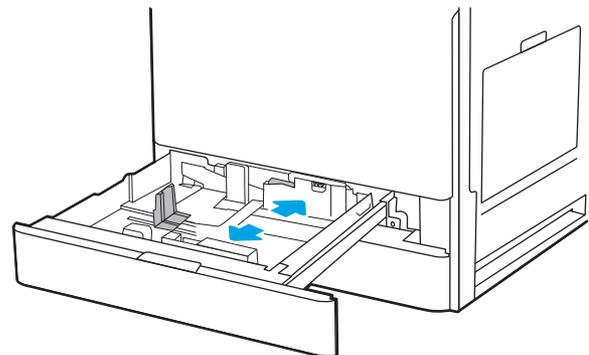
3. Passen Sie die Führung für die Papierlänge an, indem Sie die blaue Anpassungsverriegelung unten zusammendrücken, während Sie die Führung auf das verwendete Papierformat einstellen.
