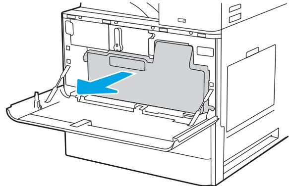
**HINWEIS:** Behalten Sie die Position des Toner auffangbehälters bei, während Sie ihn aus dem Drucker herausziehen. Dadurch wird sichergestellt, dass keine Tonerreste in den Drucker gelangen. Legen Sie den Toner auffangbehälter nach dem Herausziehen nicht seitlich mit den Löchern nach unten gerichtet ab. Legen Sie den Behälter in die leere Plastikhülle, in der sich der neue Toner auffangbehälter befand. Verschließen Sie die Plastikhülle.
