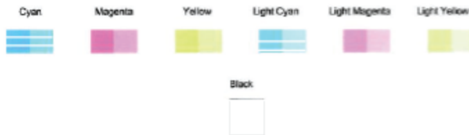
图 9-2 包含缺陷的色块示例
