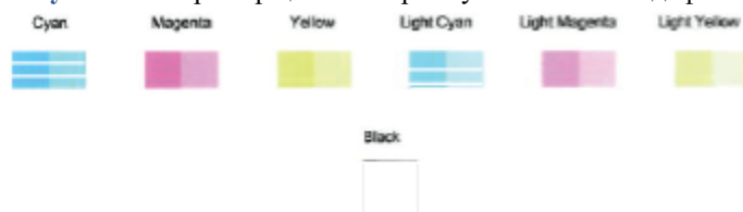
Рисунок 9-2 Пример цветных прямоугольников без дефектов
