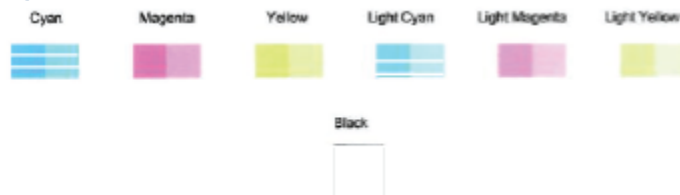
Figura 9-2 Ejemplo de bloques de color con defectos
