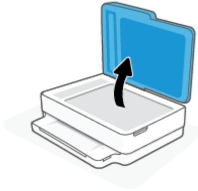
2. Cargue el original, con la cara impresa hacia abajo, en el cristal del escáner, alineado con la esquina superior izquierda.
