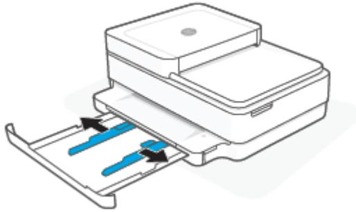
3. Introduzca uno o varios sobres en el centro de la bandeja para el papel y deslice la pila de sobres hacia dentro hasta que alcance el tope. La cara del papel que va a imprimirse debe colocarse orientada hacia abajo en la impresora.
