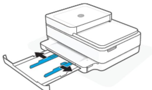
3. Introduzca una pila de papel normal o fotográfico en el centro de la bandeja para el papel con el borde corto orientado hacia la impresora. Para el papel fotográfico, asegúrese de que la cara que va a imprimirse esté orientada hacia abajo. A continuación, deslice la pila de papel hasta que se detenga.
