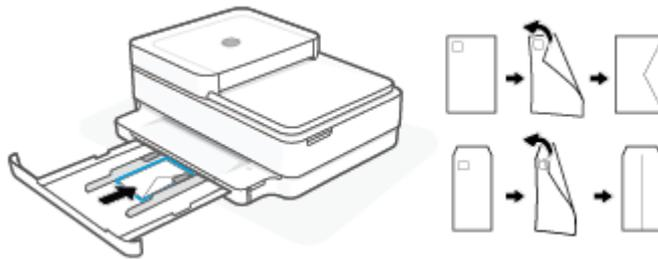
4. Deslice las guías de anchura del papel a los bordes izquierdo y derecho de la pila de sobres hasta que se detengan en ambos bordes.
