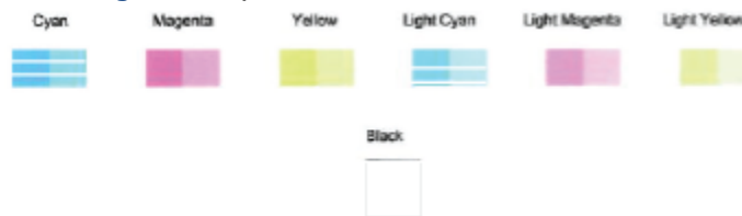
Abbildung 9-2 Beispiele für fehlerhafte Farbböcke
