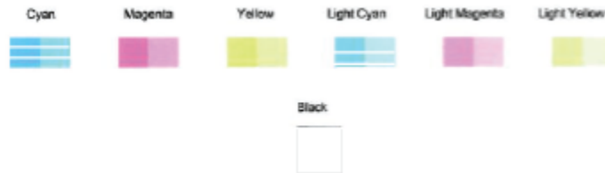
Figura 9-2 Esempi di blocchi di colore con difetti
