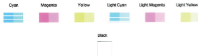
Rysunek 9-2 Przykładowe bloki kolorów z defektami
