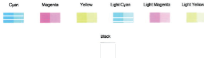
Рисунок 9-2 Кольорні блоки з дефектами
