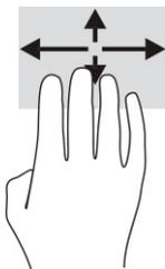
Para alterar a função deste gesto, selecione **Iniciar**, selecione **Definições**, selecione **Dispositivos** e, em seguida, selecione **Painel Táctil**. Em **Gestos com quatro dedos**, na caixa **Gestos de deslizar**, selecione uma definição de gesto.
