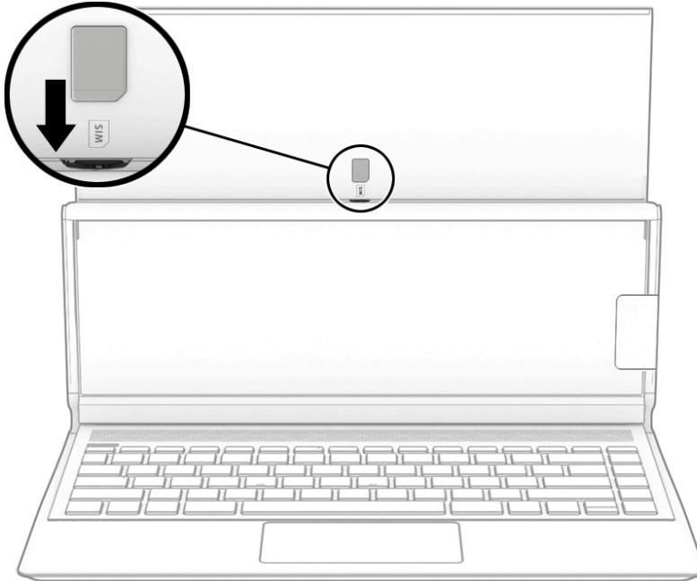
SIM カードを取り出すには、SIM カードをいったんスロットに押し込んで、固定を解除してから引き抜きます。
