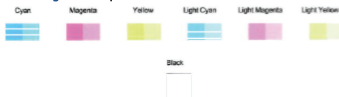
Abbildung 9-2 Beispiele für fehlerhafte Farbböcke
