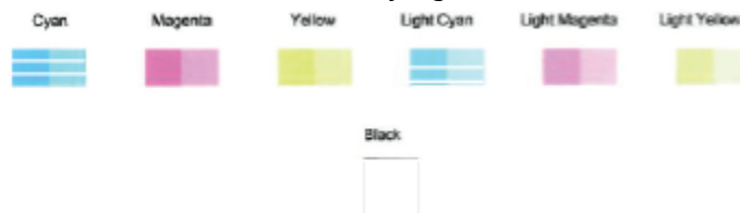
Gambar 9-2 Contoh blok warna yang cacat
