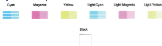
Figura 9-2 Exemple de blocuri de culoare cu defecte
