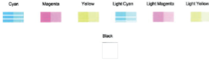
Şekil 9-2 Hatalı renk bloklarına örnekler
