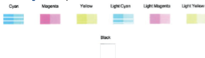
Abbildung 9-2 Beispiele für fehlerhafte Farbböcke
