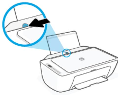
3. Insérez une ou plusieurs enveloppes à l'extrême droite du bac d'alimentation et faites glisser la pile jusqu'à ce qu'elle soit calée. Le côté à imprimer doit être orienté vers le haut.
